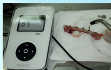
Figura 5. Osstell y medición de ISQ biológico en implantes.
